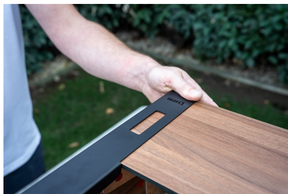
Prindere autocentrată pe colțul frontal.
